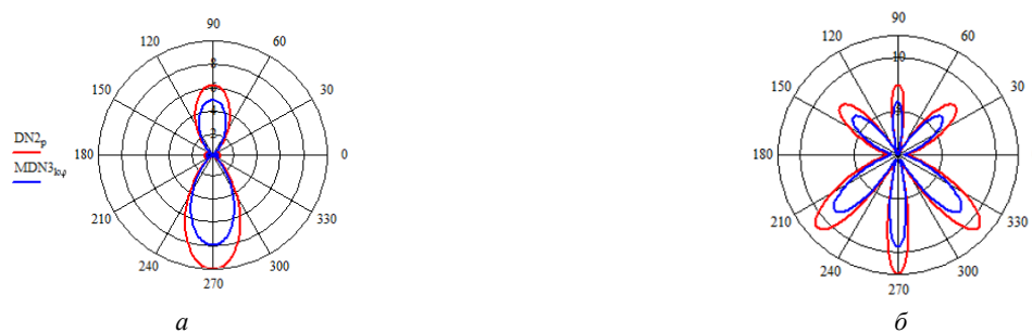
Рис. 10 – Гратка 1. Порівняння ДС розрахункові ( червоний) та асимптотичні (синій) для довжин ( a - 160 ) та ( b - 60 ) при кути падіння EMX - 90^\circ .
