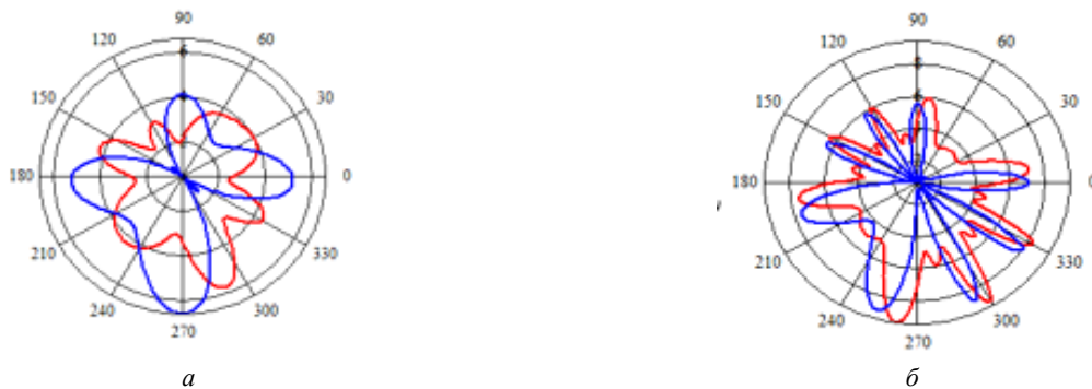
Рис. 16 – Ґратка 3. Порівняння розрахункових (червоних) та асимптотичних (синіх) ДС для довжин а – 160 та б – 60 при куті падіння ЕМХ – 90^\circ .
