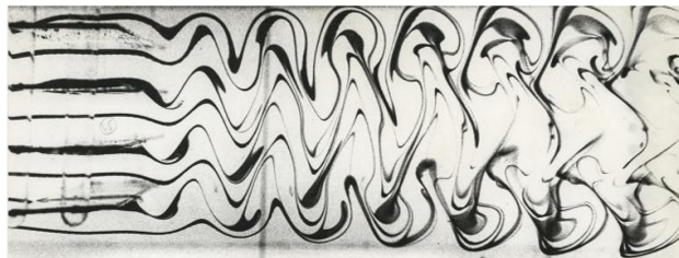
Рис. 7 – Лабораторний експеримент [6]: Синфазні коливання поліплана ( M = 4 ), P^* = 4.71 , f = 1.2 \text{ Гц} .
