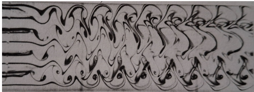
Рис. 1 – Течія навколо рухомої системи M крил ( M = 4 профілів). Лабораторний експеримент [6].
