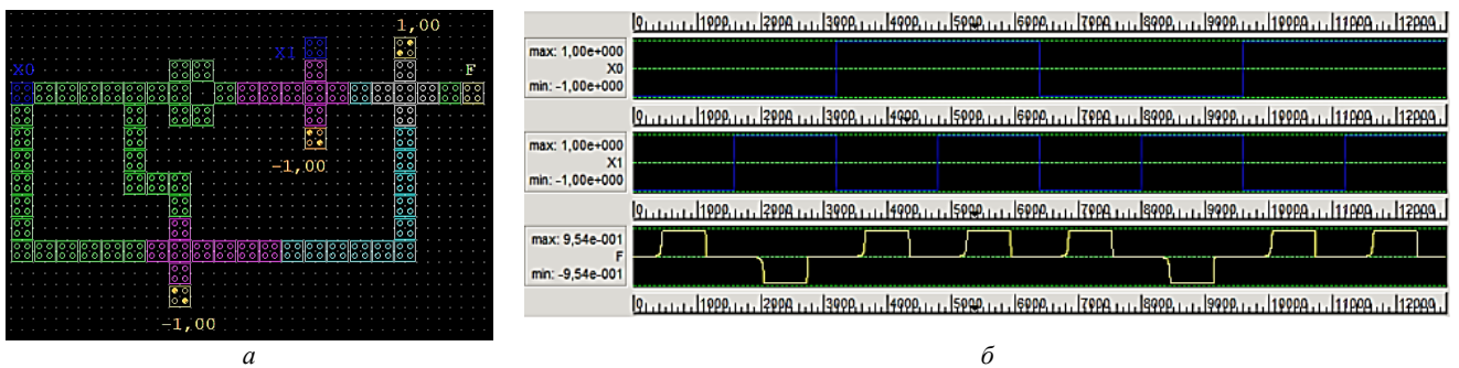
Рис. 7 – Автоматизоване проектування МНПС на КА: а – одноаргументна наносхема; б – результати часового моделювання.
