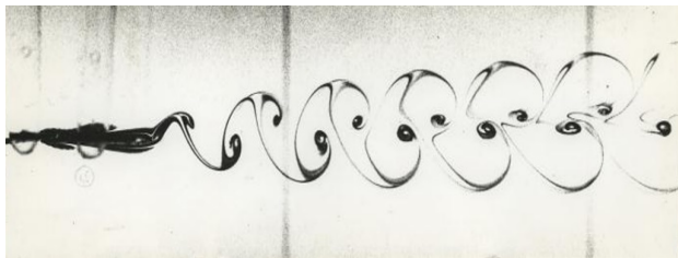
Рис. 5 – Лабораторний експеримент [6]: Коливання крила, P^* = 5.89 , f = 1.5 \text{ Гц} .
