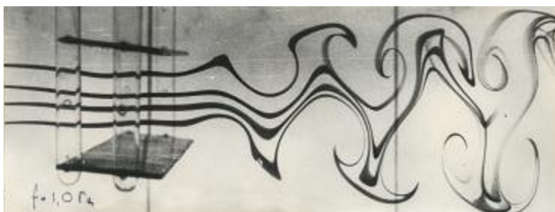
Рис. 11 – Лабораторний експеримент [6]: Синфазні коливання біплану ( M = 2 ), P^* = 3.93 , f = 1.0 \text{ Гц} .
