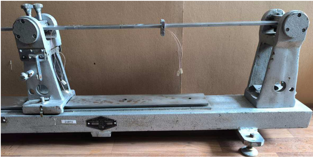
Рис. 1 – Шарнірно-оберта балка для експериментальних досліджень.
